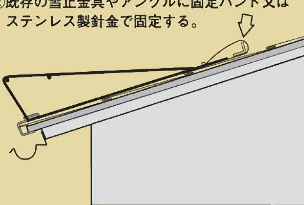
③専用取付け金具・ヴィクトリーロック、又はフェンスロック等を屋根に取り付けフェンスを固定する。
